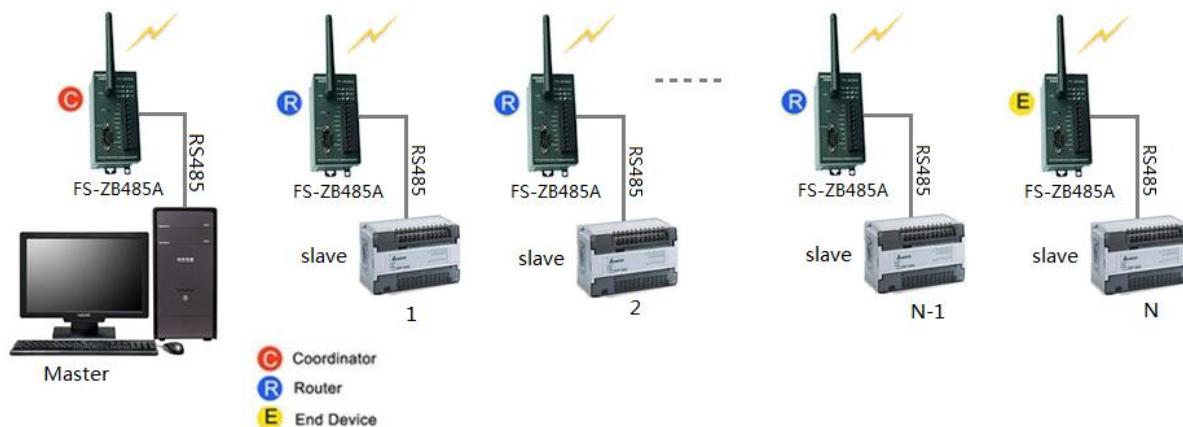
图 3 用 ZigBee 实现的 RS485 无线传输系统
