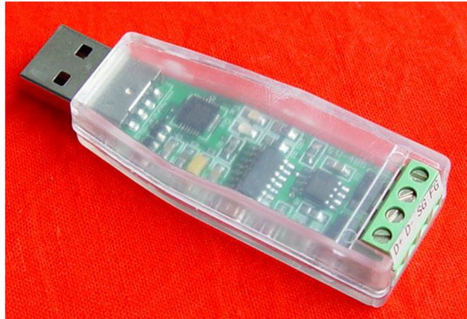
U-485 用于实现 USB 到 RS485 串口的转换，该产品的工作电源由 USB 端口供给，无需外接电源，本产品采用特有的无延时自动收发转换技术和波特率自适应技术，即插即用适合所有软件，并且具有收发使能控制，在不发送数据的待机状态时输出为高阻态，支持多点通信，有别于市售的其它同类廉价产品。本产品为微型设计，大小与 U 盘相似，内置防静电抗雷击电路，独具数据收、发指示灯。
